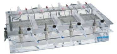
5、应用： 适用于各种组织带、肌肉、血管和微血管在药物暴露和/或电刺激时的收缩特性研究。
