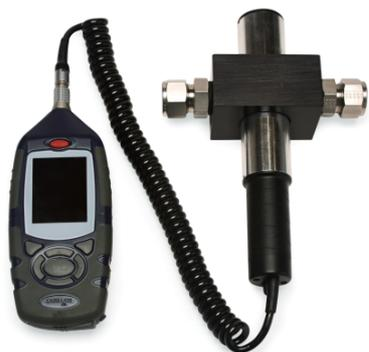
Microdust Pro是一款便携式实时气溶胶监测和数据记录仪。MicrodustPro采用激光散射测量技术，实时监测粒径和浓度，可在0-250mg 和0-2500mg/m<sup>3</sup>之间切换量程。允许实验人员实时观察气溶胶颗粒分布和浓度趋势。MicrodustPro可以与CHT的所有暴露吸入系统匹配，分辨率: 1μg/ m3。
