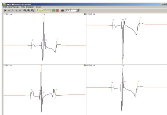
根据不同的动物、ECG的形态建立分析模板， ecgAUTO会根据设定的模板进行自动分析。
