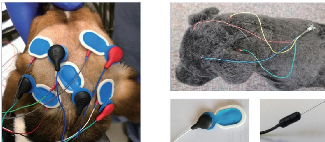
无创式、针式电极脑电遥测
